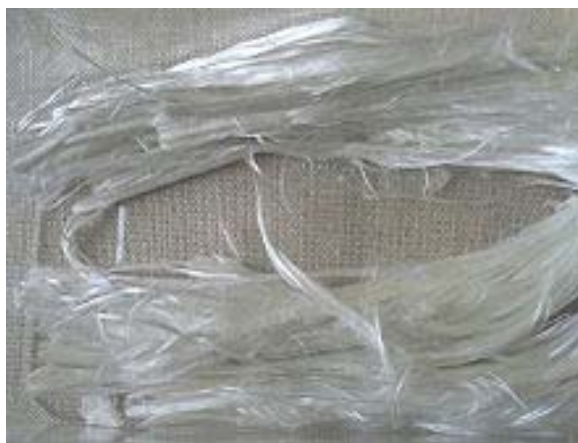
Chrysotiel asbest ( in volksmond witte asbest ) Wit, zacht, serpentijn vorm Gevaarlijk bij inademing
